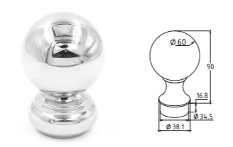
k070-2 Наконечник стойки шар, Ø38.1 мм, 400#, AISI 201
