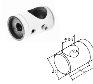
k065 Ригелдержатель на стойку под плоскость с отверстием 16.8мм, для ригеля Ø16мм, литой, внешний Ø22мм, высота 30мм
