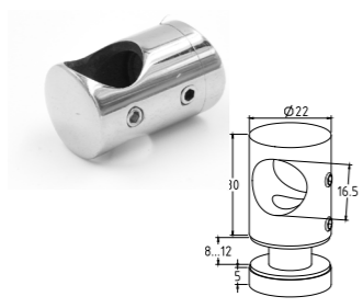
k019 Ригелдержатель на стекло 8мм Ø16мм, полированный, литой, AISI 304
