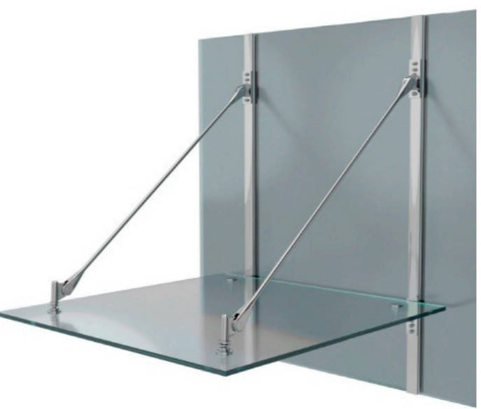
k288-V-2 V-спайдер-200мм, 2x26x38мм, 1x18x36/40мм, AISI 304 нагрузки: 1кН, 2кН
