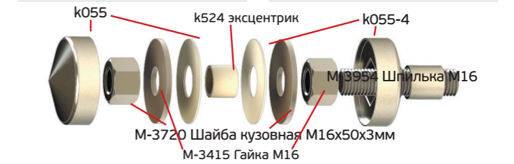
k055 M-3720 Шайба кузовная M16x50x3мм M-3415 Гайка M16
