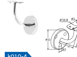
k010-4 Пристенок с ложементом под 50.8мм, вынос 70x45мм, Ø60x3мм, сварной с крышкой 25x45x2мм
