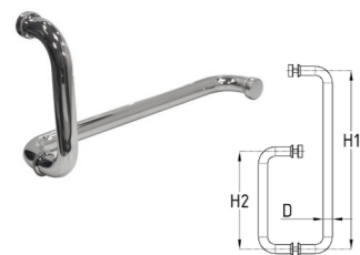
t626-19 Ручка-полотенцесушитель для стекла 8x10мм. Отверстия в стекле Ø12мм. D: 19/25; H2: 181/175; H1: 381/375
