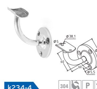
k234-4 Пристенок литой с ложементом под Ø38.1мм, вынос 65x65мм, Ø60x3мм, литой, 25x45x2мм
