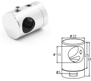
k029-3 Ригелдержатель под ригель Ø12мм на плоскость, полированный с отверстием Ø13.5мм, для ригеля 12мм, литой, внешний Ø22мм, высота 30мм
