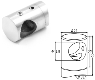
k018-3 Ригелдержатель на стойку Ø38.1x16.8мм, шлифованный, литой
