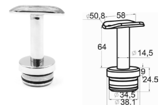
k199 Наконечник с системой фиксации на стойке Ø38.1x1.5 мм, с нерегулируемым ложементом 90° под поручень Ø50.8 мм, полированный, AISI 304
