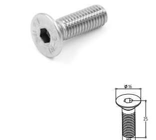
M-3978 Винт-имбус нержавеющая сталь, М8х25 потай (DIN 7991.A2)
