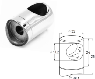
k029-9 Ригелдержатель Ø38.1x12.8мм, полированный, под ригель Ø12.0мм, AISI 316
