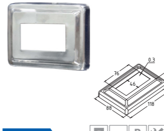
k378 304 P X Низ стойки фигурный под трубу 75x45мм, 118x88x0.3мм, высота 20мм, полированный
