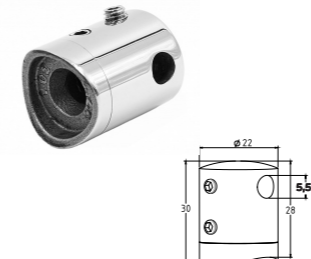
k267-3 Держатель тросика Ø5мм, 22x30мм, под Ø42.4мм, полированный, AISI 304
