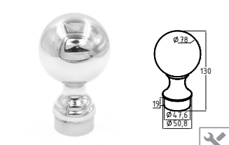
k075 Наконечник шар на стойку Ø50.8 мм, литой, полированный, AISI 304
