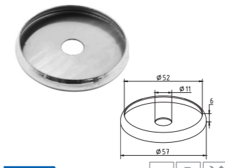
k098 201 P X Шайба подкладочная Ø50.8мм, 57x6мм, с отверстием Ø11мм
