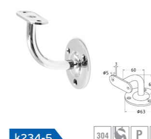
k234-5 Пристенок с ложементом на плоскость, вынос 65x65мм, Ø60x3мм, сварной, полированный
